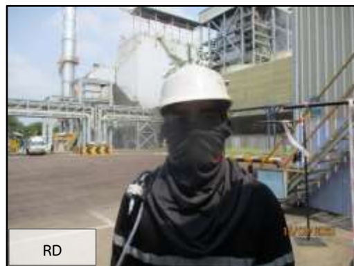
ภาพที่ 3.84 การตรวจวัดฝุ่นในสถานที่ทำงาน บริเวณจุดจ่ายเถ้าจากไซโลลงรถบรรทุก
