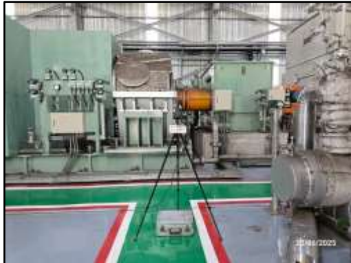
ภาพที่ 3.67 การตรวจวัดระดับเสียงในสถานที่ทำงานบริเวณอาคารเครื่องกำเนิดไฟฟ้า
