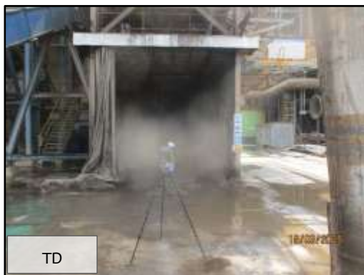
ภาพที่ 3.84 การตรวจวัดฝุ่นในสถานที่ทำงาน บริเวณจุดจ่ายเถ้าจากไซโลลงรถบรรทุก
