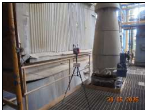
ภาพที่ 3.88 จุดตรวจวัดความร้อนในสถานที่ทำงาน บริเวณหม้อไอน้ำ
