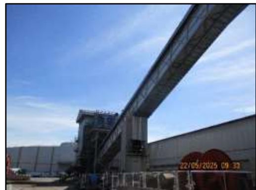
ภาพที่ 2.18 ระบบสายพานลำเลียงเชื้อเพลิงแบบปิดครอบคลุมระหว่างลำเลียงเข้าสู่ห้องเผาไหม้
