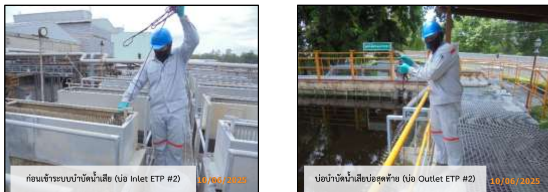
ภาพที่ 3.34 การตรวจวัดคุณภาพน้ำระบบบำบัดน้ำเสีย บริเวณก่อนเข้าระบบบำบัดน้ำเสีย และบ่อบำบัดน้ำเสียบ่อสุดท้าย
