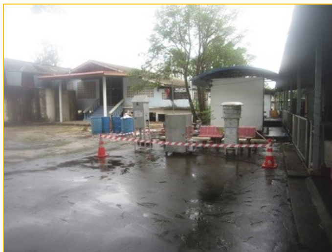
ภาพที่ 3.3.1 ภาพการตรวจวัดคุณภาพอากาศในบรรยากาศ
