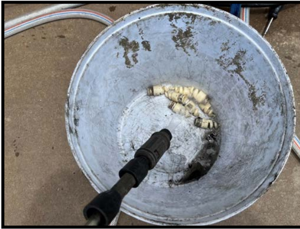
ภาพชุดที่ 5 ทำการถอดหัวสเปรย์ออกมาล้างทำความสะอาด
