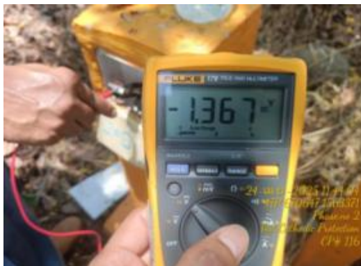
รูปที่ 2-10 ตัวอย่างการตรวจสอบการผูกธรณ
