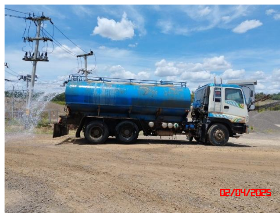
รูปที่ 13 การฉีดพรมน้ำบริเวณเส้นทางขนส่งแร่
