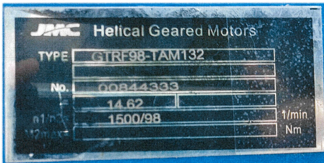
Name Plate ของเกียร์ทดรอบเครื่องเติมอากาศขนาด 10 HP
