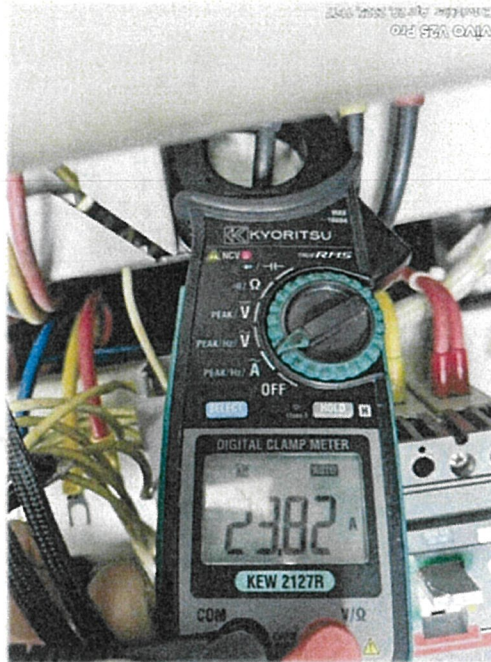
ทำการวัดปริมาณค่ากระแสไฟฟ้าของเครื่องเติมอากาศในบ่อ AT-1 (ชุดอุปกรณ์เก่า)
