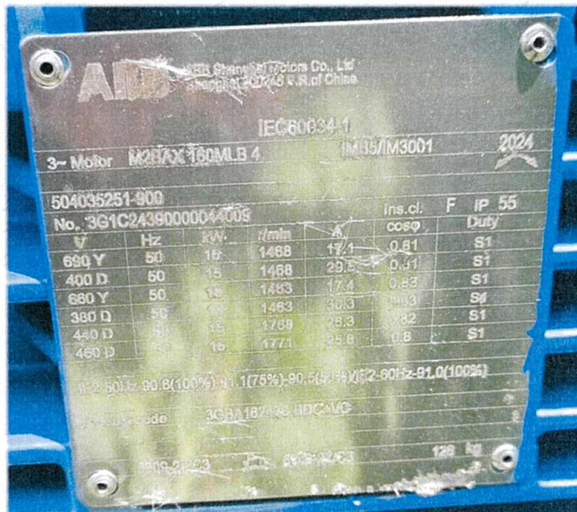
Name Plate ของมอเตอร์เครื่องเติมอากาศขนาด 20 HP
