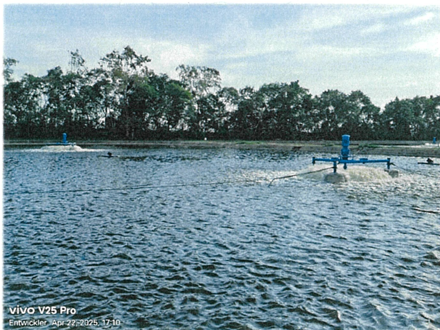
ทำการประกอบโครงสร้างเครื่องเติมอากาศและนำไปติดตั้งในบ่อ AT-1
