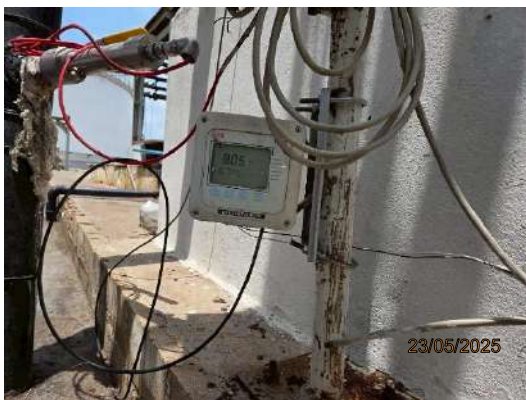
รูปที่ 2-5 เครื่องตรวจวัดคุณภาพน้ำอัตโนมัติ
