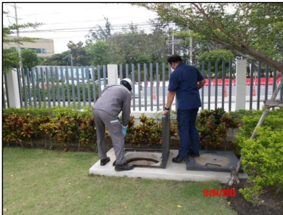
รูปที่ 3.1 การเก็บตัวอย่างคุณภาพน้ำทิ้ง บริเวณ ส่วนพักน้ำใสของระบบบำบัดน้ำเสีย
