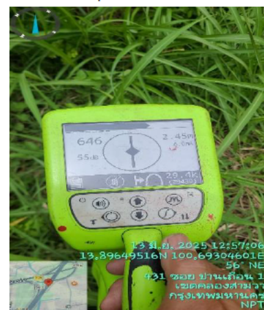
ภาพแสดงอุปกรณ์วัดความลึกขณะตรวจสอบแนวท่อน้ำฝน
