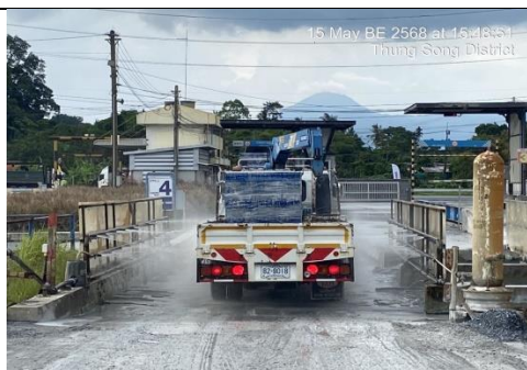
รูป 27 จัดทำบ่อล้างล้อรถบรรทุกทุก ครั้งก่อนนำรถขนส่งแร่ออกนอกบริเวณ บริษัท
