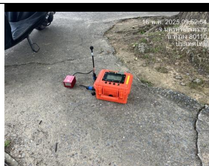
รูป 49 ตรวจวัดแรงสั่นสะเทือนและแรงอัดอากาศจากการใช้วัตถุระเบิด
