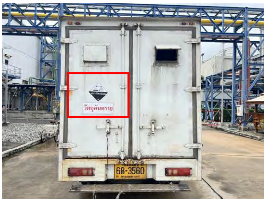
ภาพที่ 2-42 การติดเครื่องหมายฉลากและป้ายบนรถขนส่งสารเคมี
