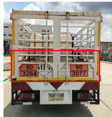
ภาพที่ 2-42 การติดเครื่องหมายฉลากและป้ายบนรถขนส่งสารเคมี
