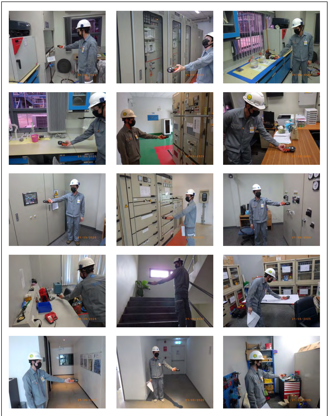
ภาพที่ 3-3 การตรวจวัดความเข้มของแสงสว่างภายในสถานประกอบการ
