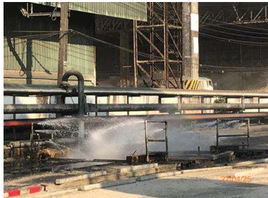
รูปที่ 2-24 พื้นที่ล้างล้อรถบรรทุก
