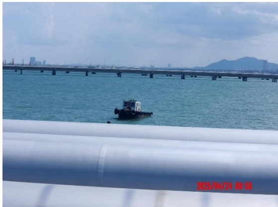
รูปที่ 2-15 เรือติดตั้งเครื่องฉีดน้ำและโฟมดับเพลิง เพื่อช่วยดับเพลิงเมื่อเกิดเหตุเพลิงไหม้บนเรือและท่อนรับน้ำมัน และท่าเรือ
