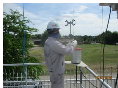
รูปที่ 3.2.2.2-1 แสดงการตรวจสอบความถูกต้องการทำงานของ AAQMS
