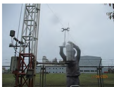
รูปที่ 3.2.2.2-1 (ต่อ) แสดงการตรวจสอบความถูกต้องการทำงานของ AAQMS
