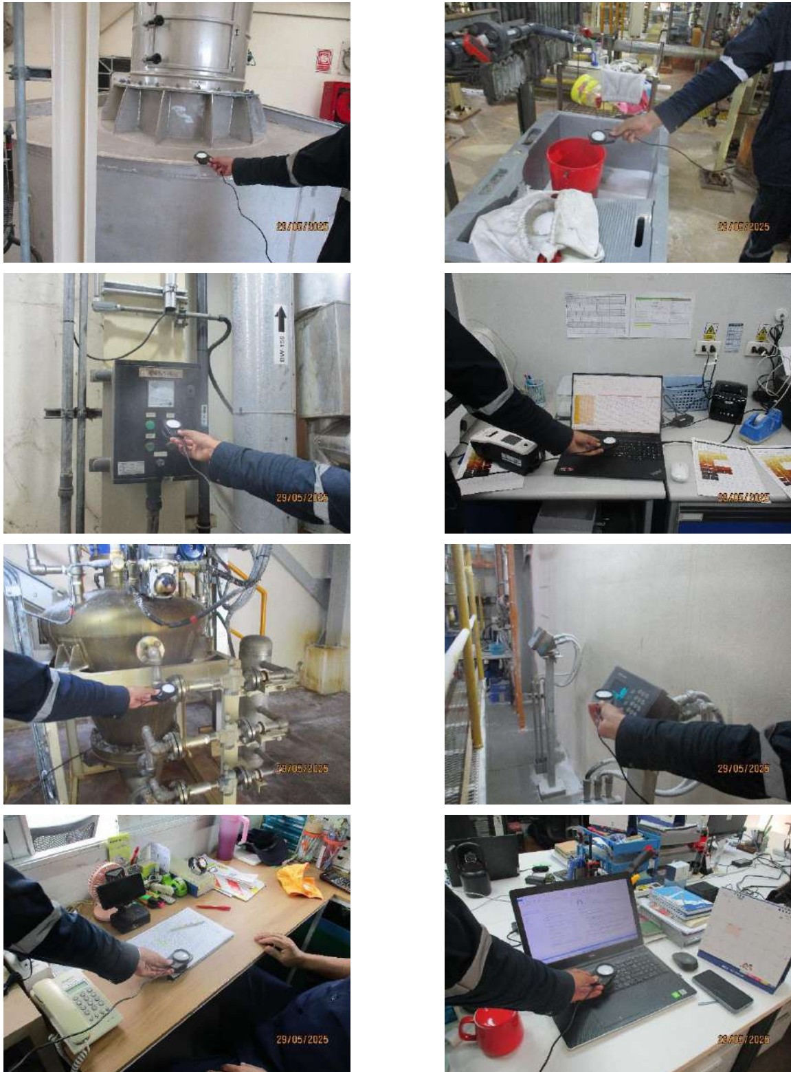
รูปที่ 3-32 การตรวจวัดความเข้มแสงสว่างในสถานประกอบการ
