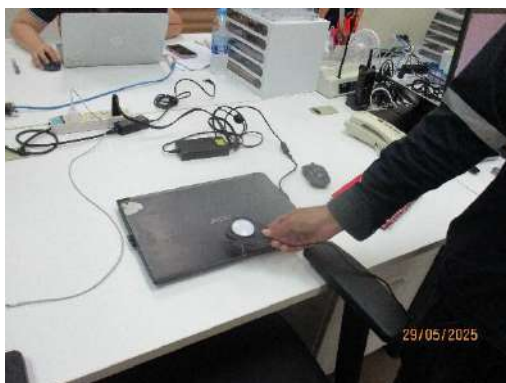
รูปที่ 3-32 การตรวจวัดความเข้มแสงสว่างในสถานประกอบการ
