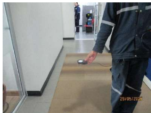
รูปที่ 3-32 การตรวจวัดความเข้มแสงสว่างในสถานประกอบการ
