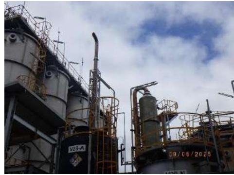
รูปที่ 2-2 หอกำจัดคลอรีน (Chlorine Eliminator)
