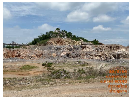
รูปที่ 2 เปิดหน้าเหมืองแบบขั้นบันได
