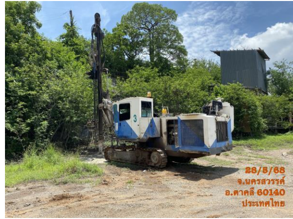
รูปที่ 8 รถเจาะระเบิดที่มีระบบกำจัดฝุ่นติดกับตัวรถ
