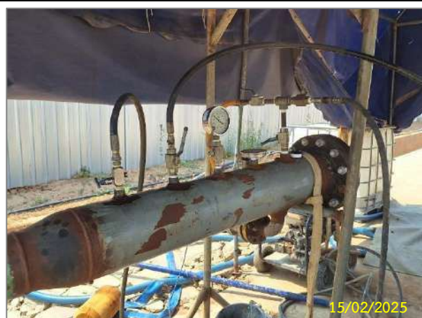
กิจกรรมการทดสอบท่อด้วยวิธีทางชลสถิต (Hydrostatic Test)
