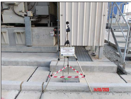
รูปที่ 3-10 การตรวจวัดระดับเสียงในพื้นที่ทำงาน บริเวณ เครื่องผลิตไฟฟ้ากังหันก๊าซ
