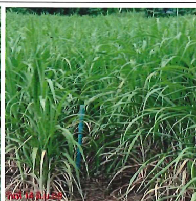
ภาพที่ 3 จุดฝังท่อเก็บตัวอย่างน้ำลึก 3 และ 1 เมตร
