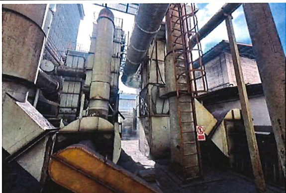
ภาพที่ 5 ปล่องระบบดักฝุ่นจาก Molding line (Line ACE)
