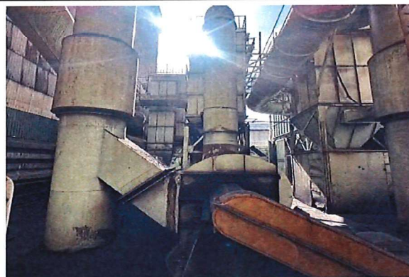
ภาพที่ 4 ปล่องระบบดักฝุ่นจาก Sand preparation (Line ACE)
