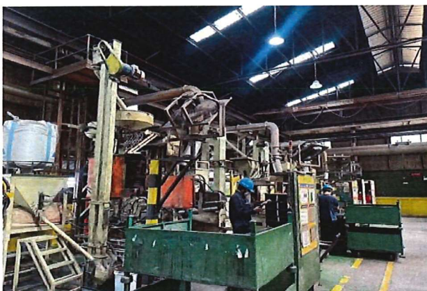
ภาพที่ 17 ระบบรวบรวมอากาศด้านบนเครื่อง shell core
