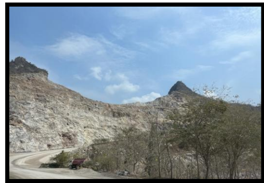
รูปที่ 2-25 หน้าเหมืองแบบขั้นบันได
