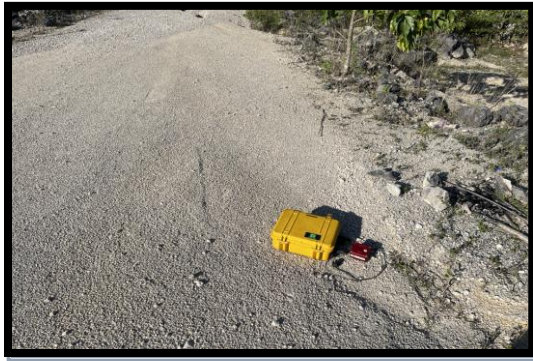
รูปที่ 2-6 การตรวจวัดความสั่นสะเทือนขอบประทานบัตร
