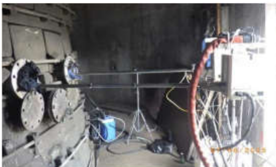
รูปที่ ง-1.5 การตรวจวัดคุณภาพอากาศจากปล่องแบบครั้งคราว ระหว่างเดือนมกราคม-มิถุนายน 2568
