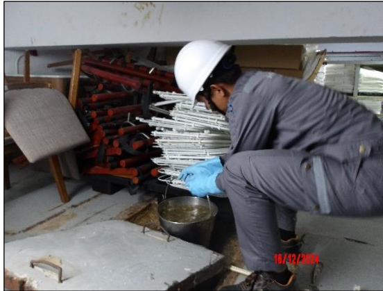
รูปที่ 3.3 การเก็บตัวอย่างคุณภาพน้ำทิ้ง บริเวณ บ่อปรับสภาพ
