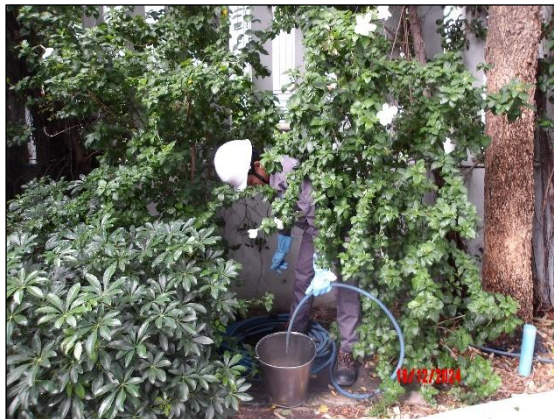
รูปที่ 3.4 การเก็บตัวอย่างคุณภาพน้ำทิ้ง บริเวณ บ่อตรวจะระบายน้ำ (บริเวณที่เชื่อมท้ายซอยเทศบาล 2)
