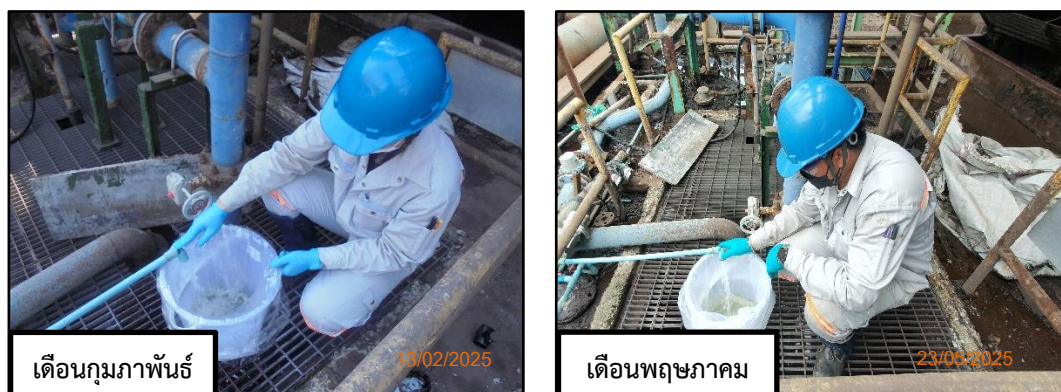
ภาพที่ 3.10 การตรวจวัดคุณภาพน้ำบริเวณน้ำทิ้งจากระบบระบายความร้อนโดยตรง (Blow down)
