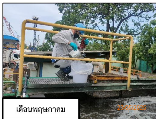
ภาพที่ 3.20 การตรวจวัดคุณภาพน้ำบริเวณน้ำเสียก่อนผ่านระบบบำบัดน้ำเสีย
