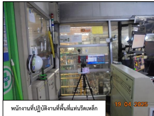
ภาพที่ 3.39 การตรวจวัดความร้อนในสถานที่ทำงานบริเวณแท่นรีดเหล็ก
