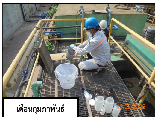
ภาพที่ 3.21 การตรวจวัดคุณภาพน้ำบริเวณน้ำเสียหลังผ่านระบบบำบัดน้ำเสีย
