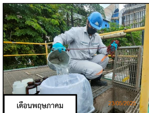
ภาพที่ 3.21 การตรวจวัดคุณภาพน้ำบริเวณน้ำเสียหลังผ่านระบบบำบัดน้ำเสีย
