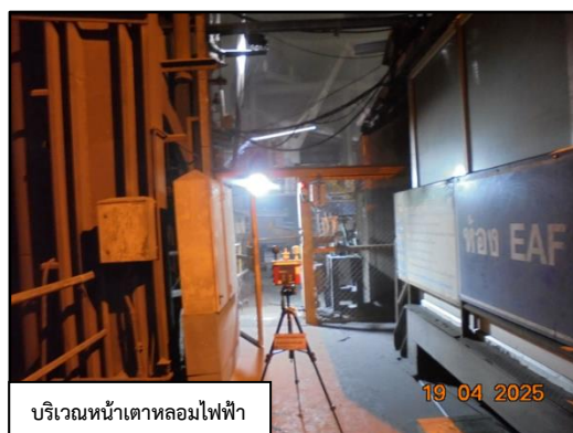
ภาพที่ 3.40 การตรวจวัดความร้อนในสถานที่ทำงานบริเวณเตาหลอมไฟฟ้า
