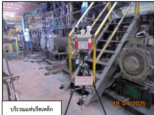
ภาพที่ 3.39 การตรวจวัดความร้อนในสถานที่ทำงานบริเวณแท่นรีดเหล็ก
