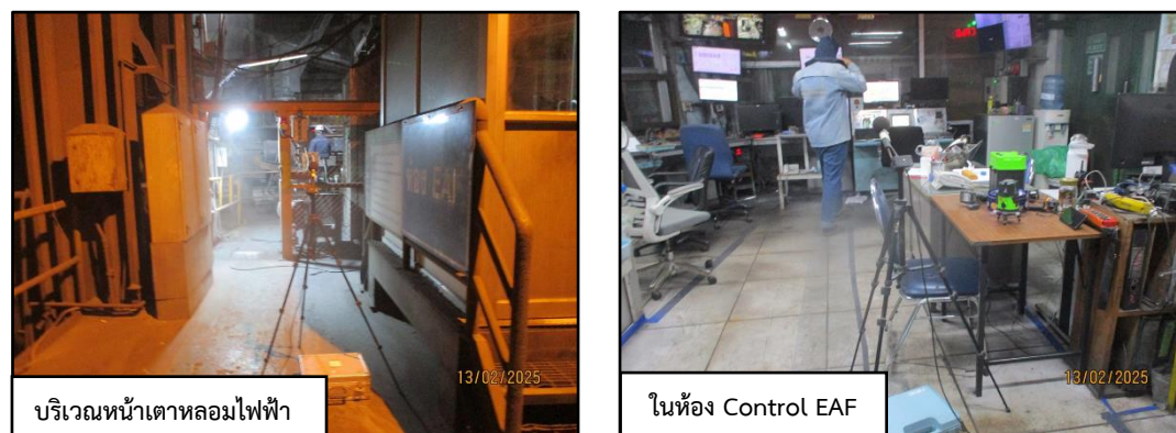
ภาพที่ 3.37 การตรวจวัดเสียง Leq 12 ชั่วโมง บริเวณหน้าเตาหลอมไฟฟ้า
