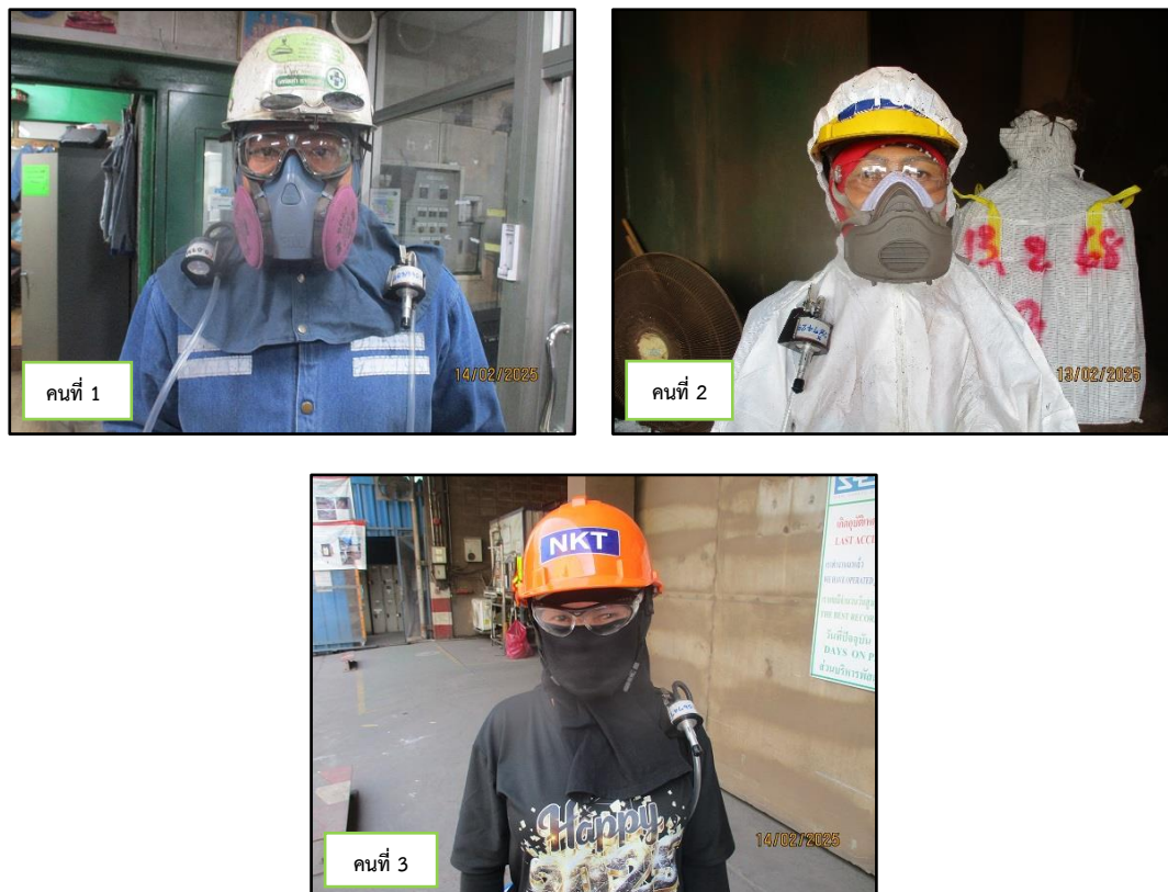
ภาพที่ 3.32 การตรวจวัดปริมาณฝุ่นในสถานที่ทำงาน (TD และ RD) พนักงานปฏิบัติงานที่เตาหลอมไฟฟ้า
