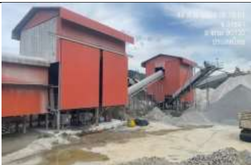
รูป Q การติดตั้งอุปกรณ์ปิดคลุมโดยตลอดพร้อมทั้งติดตั้งเครื่องฉีดสเปรย์น้ำ
