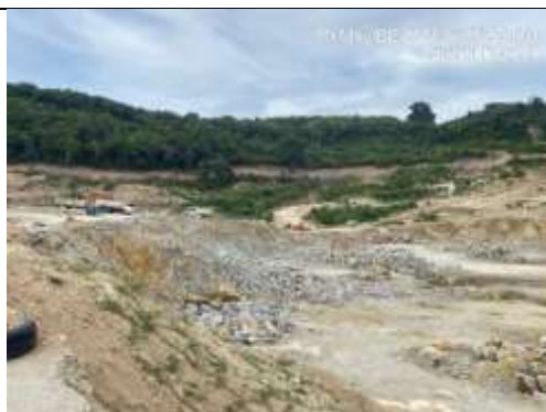
รูป A หน้าเหมืองปัจจุบันที่เป็นชั้นบันไดและเส้นทางลำเลียง
