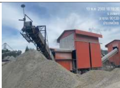
รูป P การปิดคลุม เครื่องบด ชูตตะแกรง สายพานและสเปรย์น้ำ
