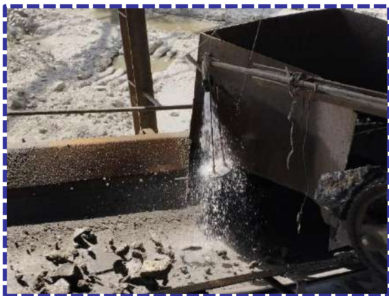
รูปที่ 8 ระบบสเปรย์น้ำ
