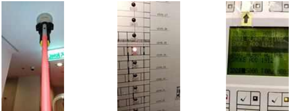
FL 24 หน้าลิฟท์ลูกค้า TEST SMOKE DETECTOR 1 SET..NORMAL
