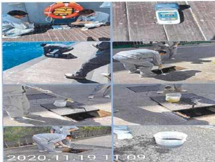
ภาพประกอบที่ 20 ถึงเก็บน้ำสำรองและการเก็บตัวอย่างนำไปตรวจวิเคราะห์
