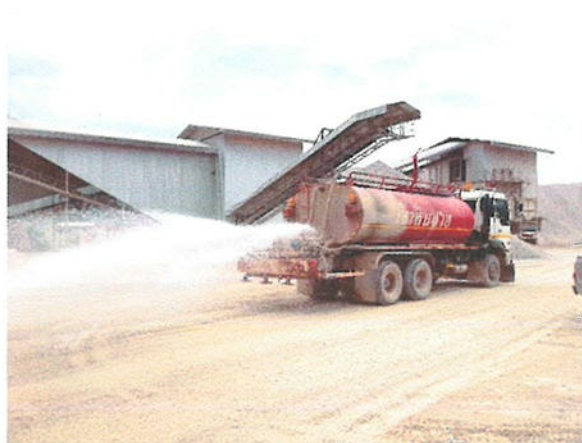
รูปที่ 23 รถบรรทุกน้ำฉีดพรมบริเวณโรงโม่หิน
