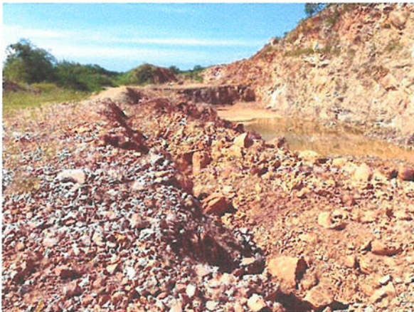
รูปที่ 2 การเปิดหน้าเหมืองเป็นชั้นบันไดจากทิศตะวันออกเฉียงเหนือสู่ทิศตะวันตกเฉียงใต้
