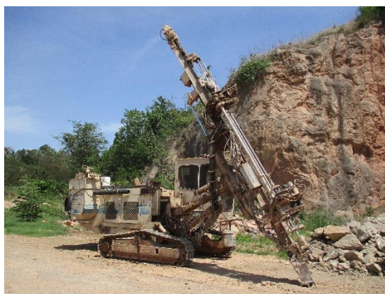
รูปที่ 11 เครื่องเจาะระเบิดที่มีอุปกรณ์เก็บฝุ่นติดไว้กับหัวเจาะ
