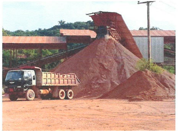
รูปที่ 5 เลือกดินจากหน้าเหมืองนำมาผสม เป็นผลิตภัณฑ์หินคลุกเพื่อจำหน่าย
