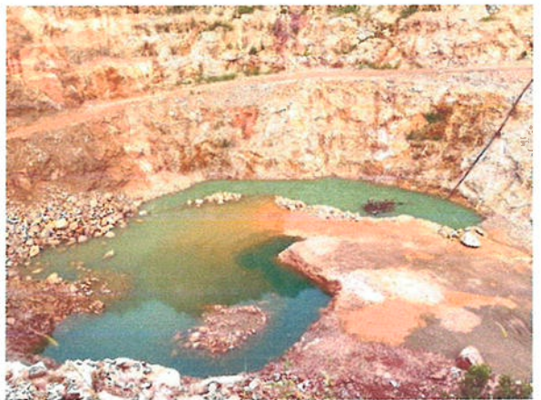
รูปที่ 6 พัฒนาพื้นที่รับน้ำขุ่นข้นและตะกอนดิน (Sump) ที่เกิดจากการชะล้างบริเวณหน้าเหมือง
