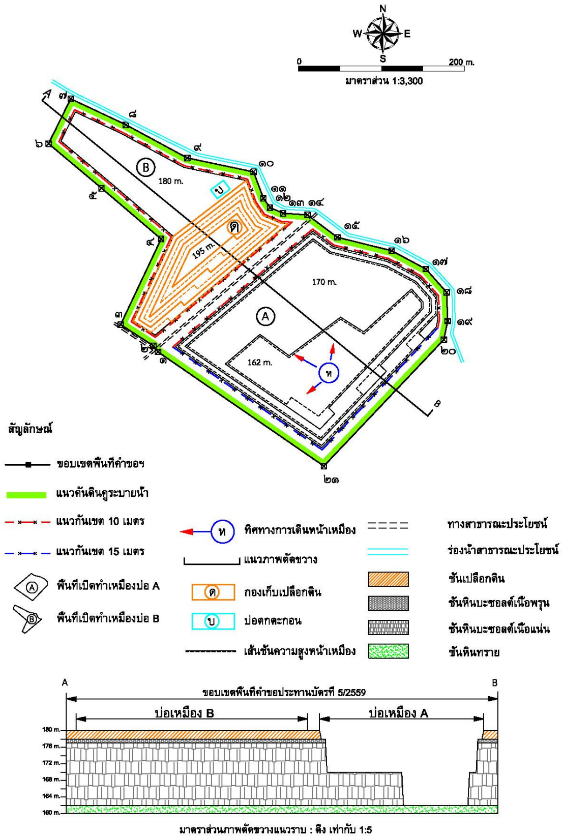
รูปที่ 1-7 แผนผังการทำเหมืองเมื่อสิ้นสุดปีที่ 3
