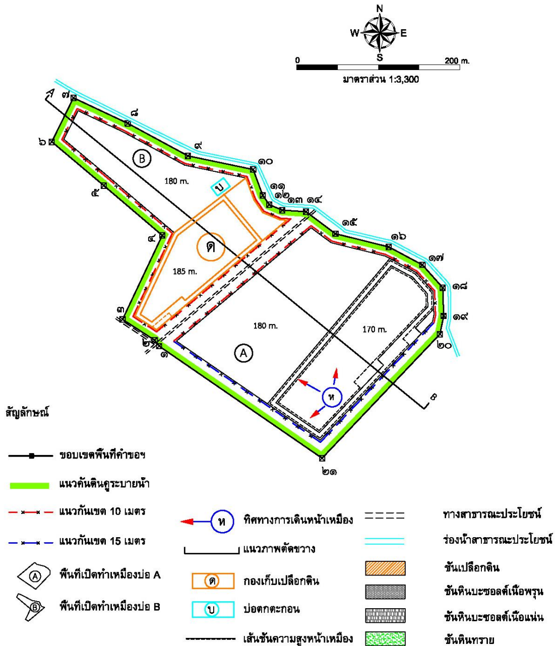
รูปที่ 1-5 แผนผังการทำเหมืองเมื่อสิ้นสุดปีที่ 1
