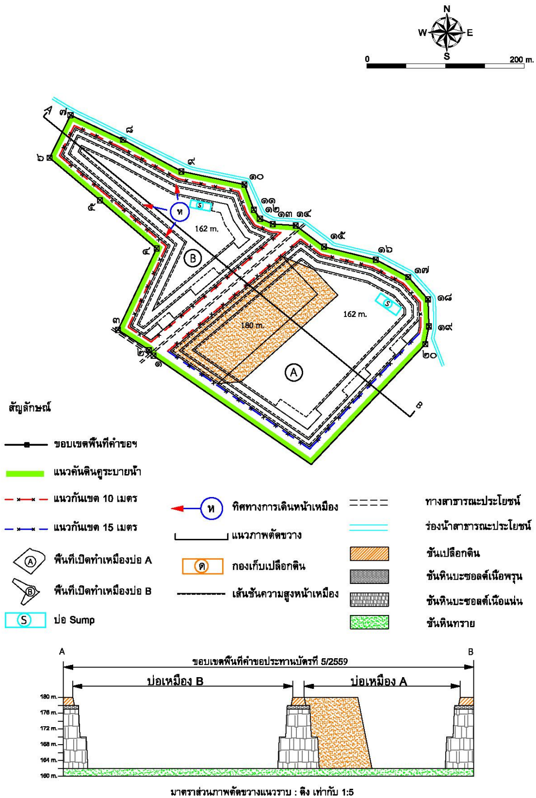
รูปที่ 1-9 แผนผังการทำเหมืองเมื่อสิ้นสุดปีที่ 8
