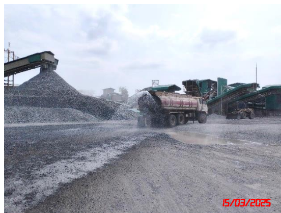
การฉีดพรมน้ำของโรงโม่หินอารีย์สันติก่อสร้าง
