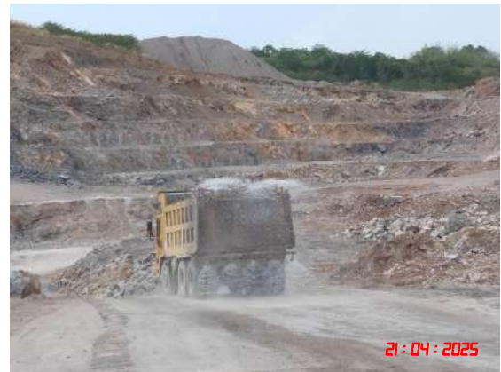
รูปที่ 9 การฉีดพรมน้ำเพื่อลดการฟุ้งกระจายของฝุ่นละออง
