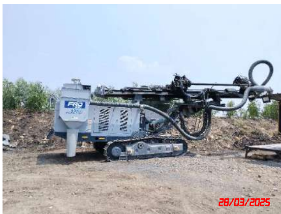
รูปที่ 7 รถเจาะรูระเบิดที่มีอุปกรณ์เก็บฝุ่นติดไว้กับหัวเจาะ
