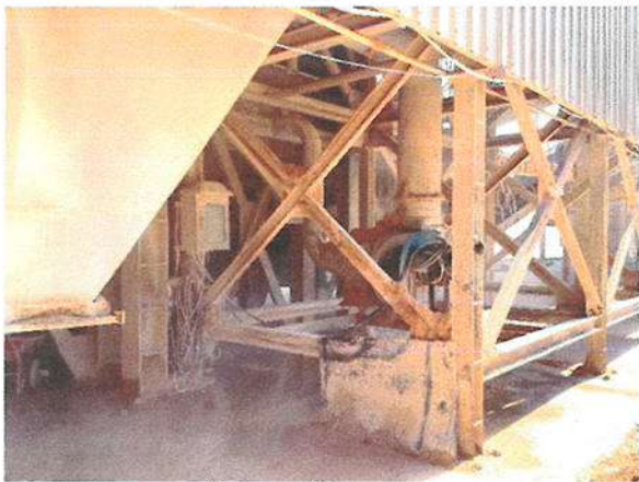
รูปที่ 20 ติดตั้งและใช้งานระบบชุดฝุ่นละออง ขณะโม่หินแบบ Bag Filter บริเวณ Secondary & Tertiary Crusher
