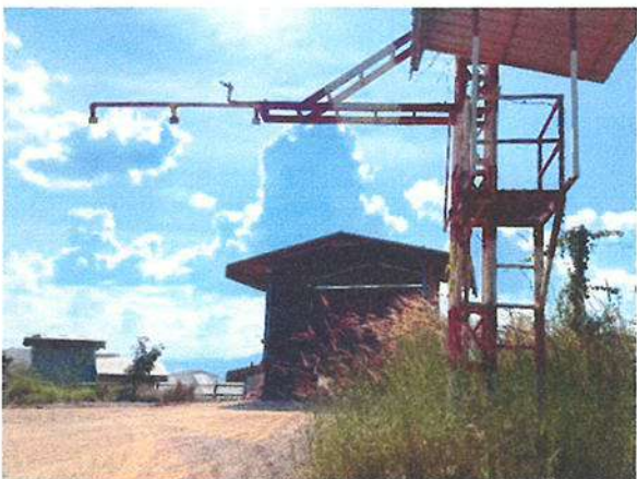
รูปที่ 21 ระบบสเปรย์น้ำบนกระเบรรถบรรทุกหิน ก่อนเทหินลงปากโม่
