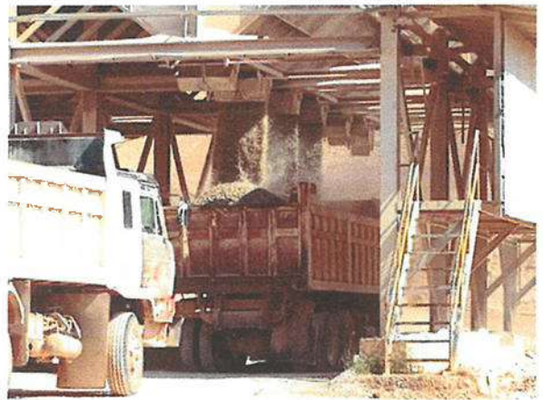
รูปที่ 17 การออกแบบยังเก็บหิน เพื่อลดการฟุ้งกระจายของฝุ่นหินจากปลายสายพาน
