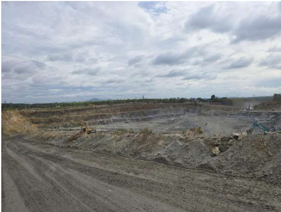
ภาพที่ 1 ทำเหมืองแบบขั้นบันได
