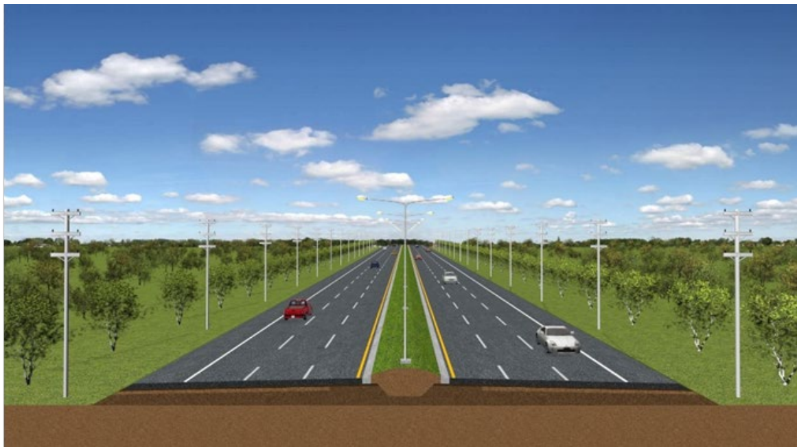
รูปที่ 2.1.1-3 รูปตัดและรูปแบบถนนขนาด 6 ช่องจราจร (ไป-กลับ) ช่วงจาก กม.34+639 ถึง กม.42+325 และช่วงจาก กม.43+435 ถึง กม.47+765
