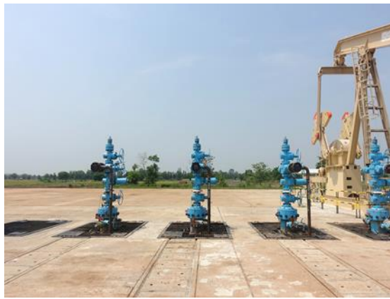
ชุดวาล์วหัวบ่อ (Christmas Tree) และบ่อเก็บน้ำบริเวณวาล์วหัวบ่อ (Well Cellar Pit)
