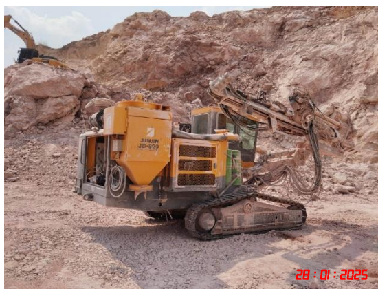
รูปที่ 18 เครื่องเจาะระเบิดที่มีอุปกรณ์เก็บฝุ่นติดไว้กับหัวเจาะ
