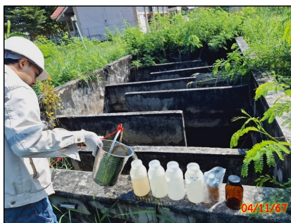
จุดเก็บน้ำทิ้งหลังผ่านระบบบำบัดน้ำเสีย บริเวณจุดปล่อยน้ำออกจากกระบบบำบัดน้ำเสีย
