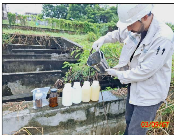
จุดเก็บน้ำทิ้งหลังจากผ่านระบบบำบัดน้ำเสีย บริเวณจุดปล่อยน้ำออกจากระบบบำบัดน้ำเสีย
