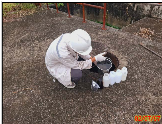
จุดเก็บน้ำทีก่อนเข้าสู่ระบบบำบัดน้ำเสีย
