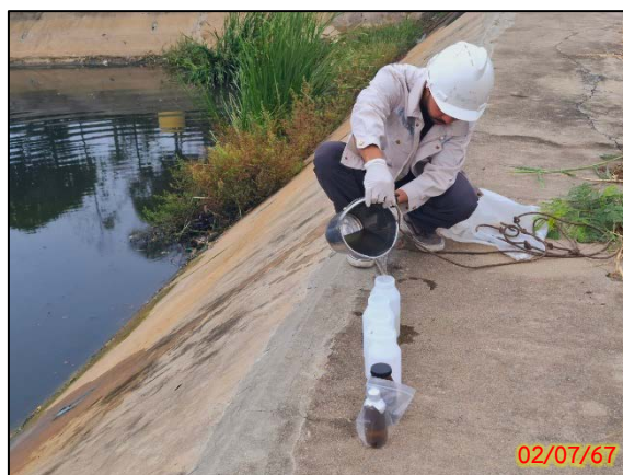
จุดเก็บน้ำทีกจากบ่อกักสุดท้ายก่อนระบายออกนอกโครงการ
