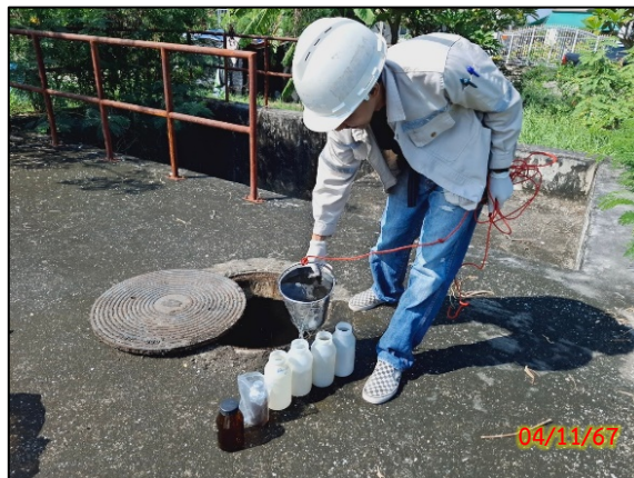
จุดเก็บน้ำทิ้งก่อนเข้าสู่ระบบบำบัดน้ำเสีย
