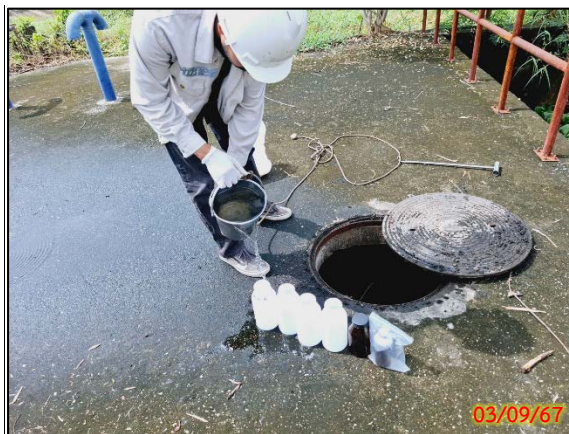
จุดเก็บน้ำทิ้งก่อนเข้าสู่ระบบบำบัดน้ำเสีย
