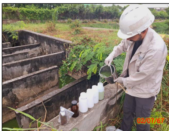
จุดเก็บน้ำทีกหลังผ่านระบบบำบัดน้ำเสีย บริเวณจุดปล่อยน้ำออกจากกระบบบำบัดน้ำเสีย
