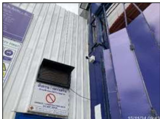
ภาพที่ 32 เครื่องวัดคุณภาพอากาศแบบ Real time
