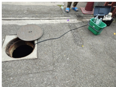
ภาพที่ 5 เก็บตัวอย่างที่ป่อตรวจคุณภาพน้ำถึงก่อนระบายออกสู่ท่อระบายน้ำสาธารณะ
