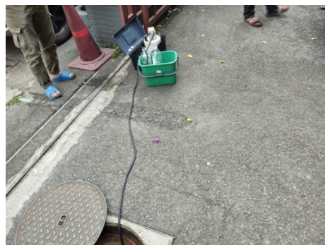
ภาพที่ 5 เก็บตัวอย่างที่ป่อตรวจคุณภาพน้ำถึงก่อนระบายออกสู่ท่อระบายน้ำสาธารณะ
