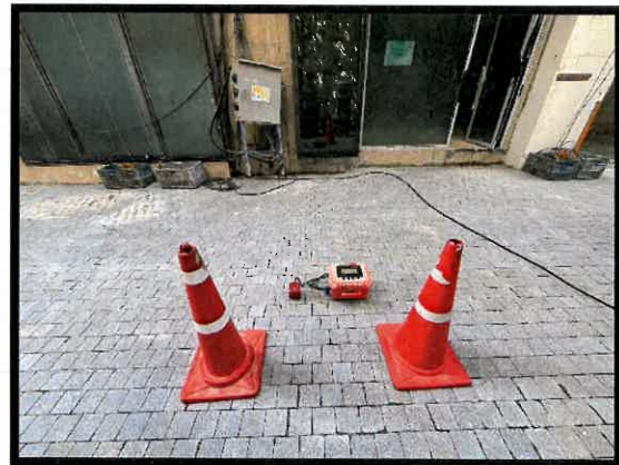
รูปที่ 3-10 ติดตั้งเครื่องวัดความสั่นสะเทือนในพื้นที่ก่อสร้าง
