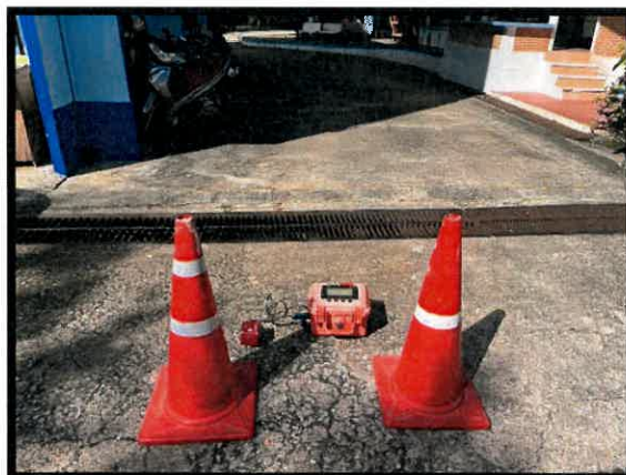
รูปที่ 4.3.3-2 แสดงการตรวจวัดความสั่นสะเทือน (บริเวณโรงเรียนดาราคาม)
