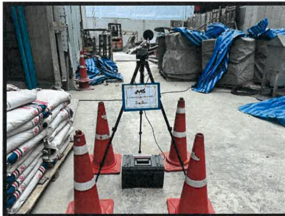
รูปที่ 4.3.2-11 แสดงการตรวจวัดระดับเสียงโดยทั่วไป (บริเวณพื้นที่โครงการ)
