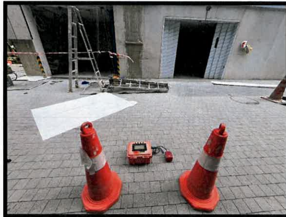
รูปที่ 4.3.3-1 แสดงการตรวจวัดความสั่นสะเทือน (บริเวณพื้นที่โครงการ)
