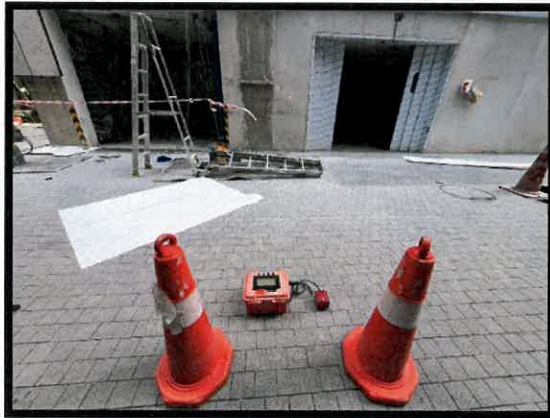
รูปที่ 3-10 ติดตั้งเครื่องวัดความสั่นสะเทือนในพื้นที่ก่อสร้าง
