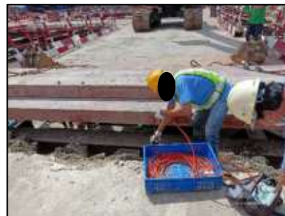
รูปที่ 75 การตรวจวัดการเคลื่อนตัวของดิน ด้วย Inclinator
