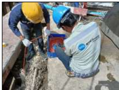
รูปที่ 75 การตรวจวัดการเคลื่อนตัวของดิน ด้วย Inclinator
