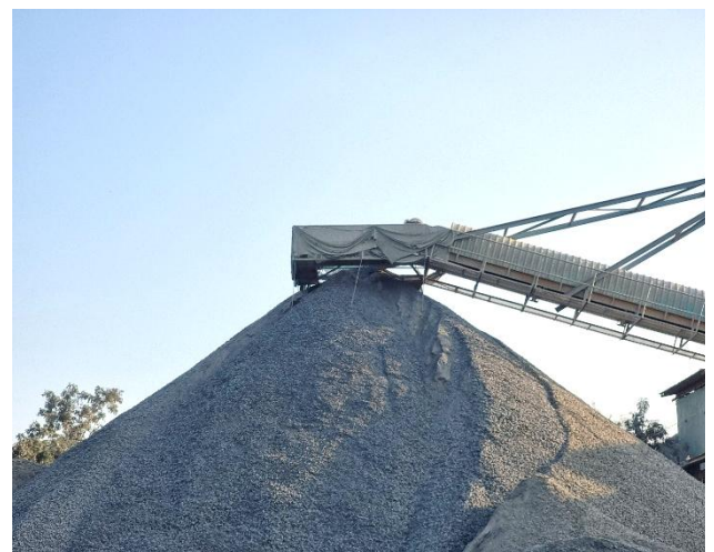
รูปที่ 2-8 (ต่อ) สายพานลำเลียงที่มีการปิดคลุม และติดสเปรย์น้ำ
