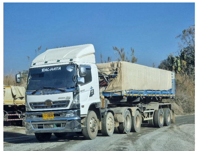
รูปที่ 2-22 รถบรรทุกปิดคลุมแร่ด้วยผ้าใบมิดชิด
