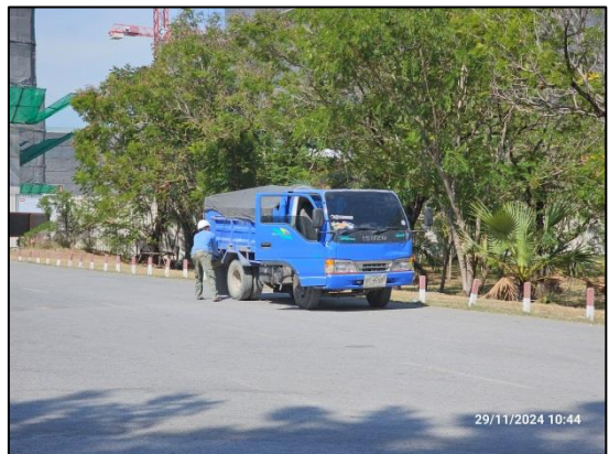
รูปที่ 24 ปิดคลุมกระบะบรรทุกของรถบรรทุกดิน หรือวัสดุอุปกรณ์ก่อสร้าง
