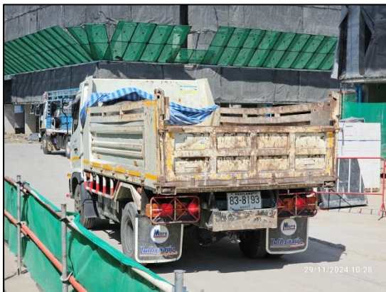
รูปที่ 24 ปิดคลุมกระบะบรรทุกของรถบรรทุกดิน หรือวัสดุอุปกรณ์ก่อสร้าง
