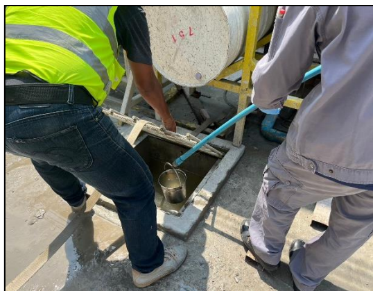
รูปที่ 4.13 การเก็บตัวอย่างคุณภาพน้ำทิ้ง บริเวณบ่อกักน้ำสุดท้ายก่อนระบาย ออกจากโครงการ
