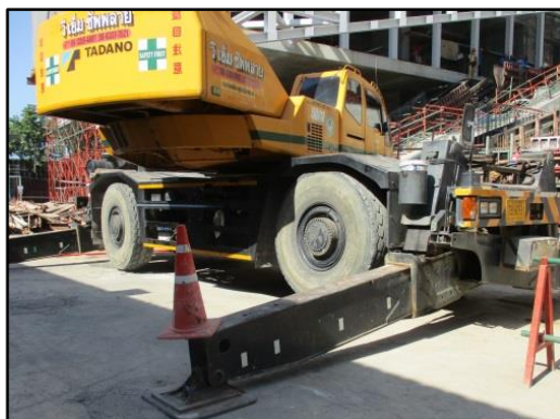
รูปที่ 123 วัสดุป้องกันและดูดซับการสั่นสะเทือนรองรับไว้ได้เครื่องจักร
