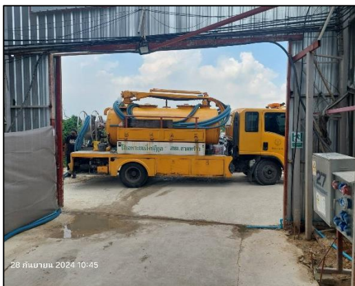
ภาพที่ 61 กิจกรรมสูบลากตะกอน
