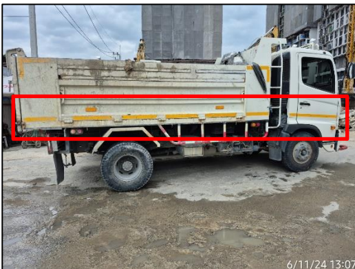
ภาพที่ 56 แผ่นสะท้อนแสงท้ายรถบรรทุก
