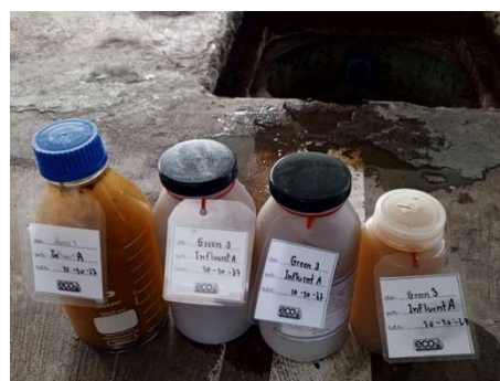
ภาพที่ 3.2-1 การเก็บตัวอย่างน้ำทิ้งของระบบบำบัดชุด A
