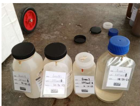
ภาพที่ 3.2-2 การเก็บตัวอย่างน้ำทิ้งของระบบบำบัดชุด B
