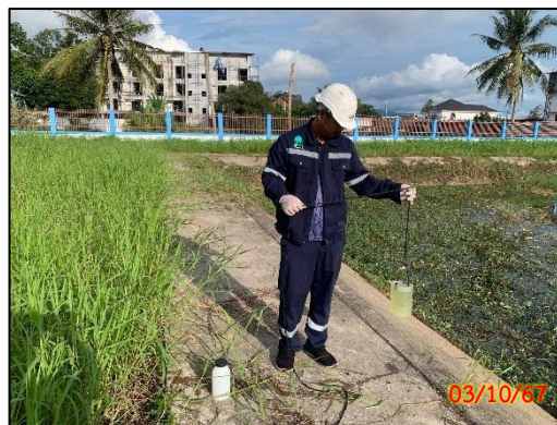
จุดเก็บน้ำตรงบ่อพักน้ำสุดท้าย ก่อนระบายลงร่องน้ำระบายน้ำข้างทางริมถนนพระยาตรัส
